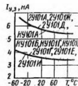
Зависимости отпирающего постоянного тока управления от температуры
