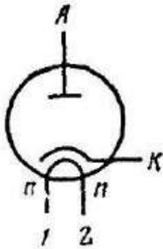
Диоды сверхвысокочастотные для детектирования импульсных сигналов СВЧ. Оформление — в металлоглазной оболочке, сверхминиатюрное (рис. 1Д). Масса 3,5 г.
