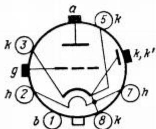
$K^1$  — вывод высокочастотный
