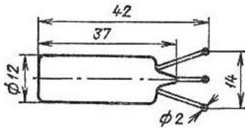
Тиратрон тлеющего разряда для преобразования электрических сигналов малой мощности, а также для работы в качестве ионного реле.
