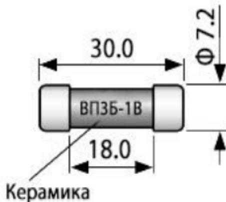
Габаритные и установочные размеры вставки плавкой ВПЗБ-1В.
