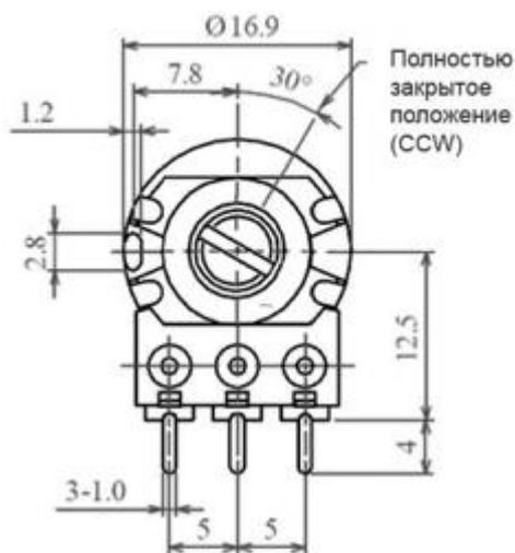
Размещение монтажных отверстий в плате
