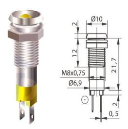
Светодиодные индикаторы, монтажный диаметр 8 мм, корпус латунный хромированный - МА, чёрный хром - МВ, крепление резьбовое под гайку. Необходимые для монтажа материалы в комплекте. Расшифровка: КИПД 102 – тип индикатора, 1 – выводы под пайку/клемму 2,8х0,5мм, МА – тип корпуса, К – цвет свечения красный, отсутствие буквы – тип колбы (матовый, соответствует цвету свечения),
