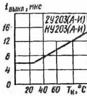
Зависимость времени выключения от температуры корпуса
