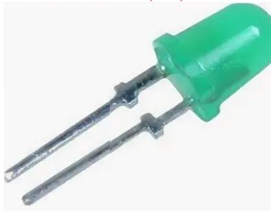
Светодиод круглый LED яркий зеленый с диспергатором. Полупроводниковый источник света с прямым напряжением 2.4 В и силой тока 20 мА. Распространено и другое название - DIP светодиод, DIP светодиод. Корпус пластмассовый прозрачный. Вывода однонаправленные радиальные, гибкие, проволочного типа. Анодный вывод длиннее. Применяется в качестве светоизлучающего источника в различных приборах. Условные обозначения КИПД35И-Л:
