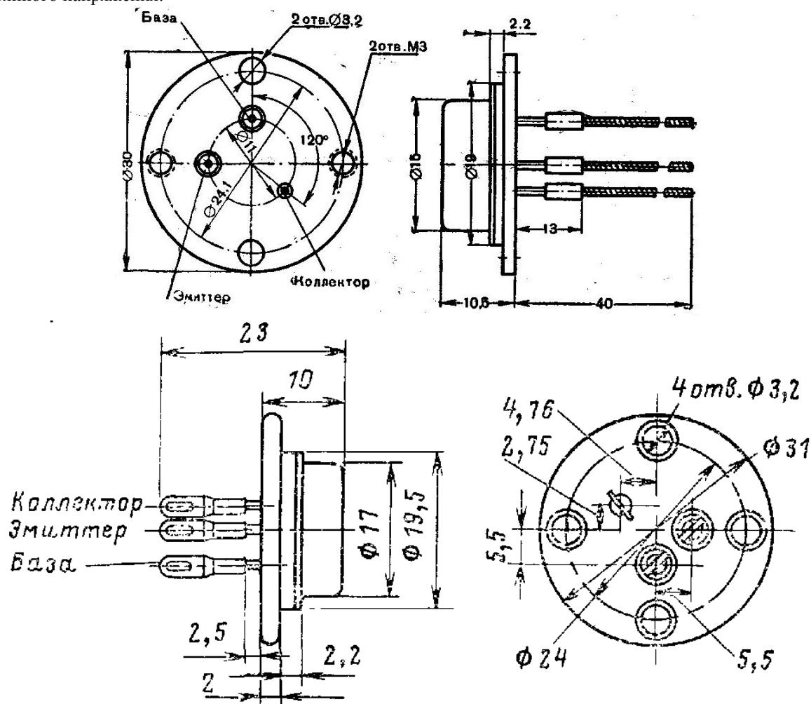
Выпускаются в металлическом сварном баллоне со стеклянными изоляторами. Вывод коллектора соединен с корпусом. Вес транзистора 14,5 г.
