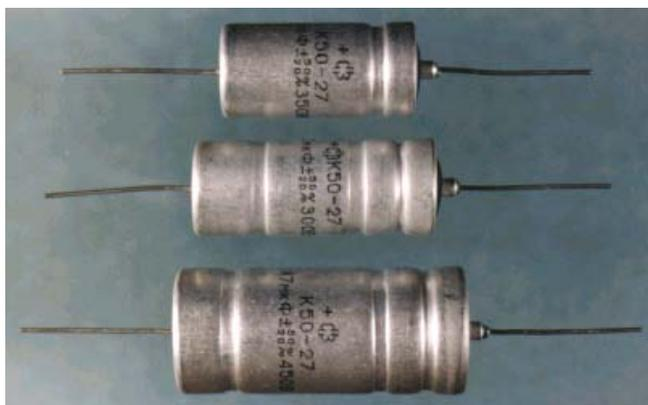
Конденсаторы оксидно-электролитические алюминиевые. Предназначены для работы в цепях постоянного, пульсирующего тока и в импульсных режимах. Изготавливаются в обычном и всеклиматическом исполнении. Корпус цилиндрический алюминиевый. Все контакты сварные. При обычном исполнении корпус изолирован полиэтиленовой трубкой.
