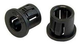
Кабельный ввод типа SB— простое и эффективное пластиковое изделие, предназначенное для защиты кабеля малого диаметра (пучка проводов) в местах его присоединения к металлическим корпусным изделиям. Устанавливается без применения инструментов нажатием руки, имеет защиту от выпадения в виде защелок. Предохраняет оболочку кабеля или изоляцию проводов от повреждения острыми краями отверстий в металлических стенках корпусов.
