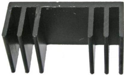
Радиатор охлаждения воздушный RUICHI BLA051-15, алюминиевый с чернением обеспечивает работу полупроводникового прибора в заданных тепловых режимах. В каждом случае необходим индивидуальный расчет площади радиатора для конкретного прибора.
