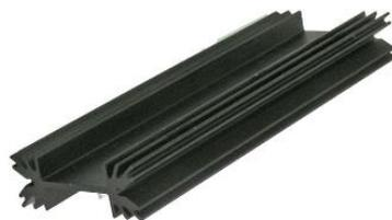
Радиатор охлаждения воздушный RUICHI BLA024-100, алюминиевый с чернением обеспечивает работу полупроводникового прибора в заданных тепловых режимах. В каждом случае необходим индивидуальный расчет площади радиатора для конкретного прибора.
