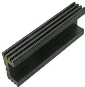
Радиатор охлаждения воздушный RUICHI BLA010-50, алюминиевый с чернением обеспечивает работу полупроводникового прибора в заданных тепловых режимах. В каждом случае необходим индивидуальный расчет площади радиатора для конкретного прибора.
